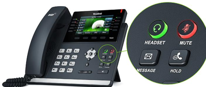
Durch Drücken der Mute-Taste kann das Headset-Mikrofon stummgeschaltet werden (Taste leuchtet in diesem Fall). Erneutes Drücken der Mute-Taste schaltet das Mikrofon wieder an (Taste leuchtet nicht mehr).
